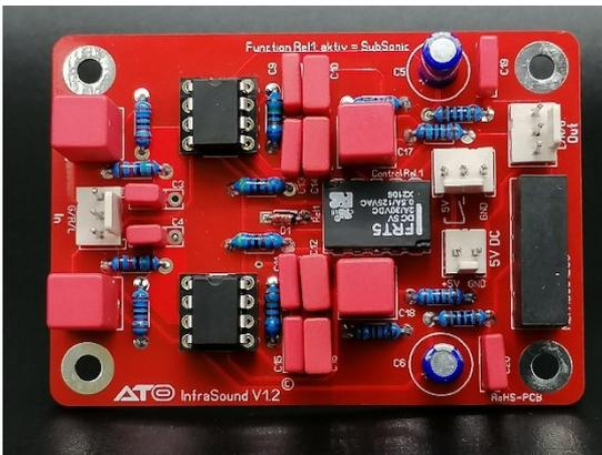
Wenn du alles kontrolliert hast, kannst du die Platine in Betrieb nehmen, indem du erst mal nur die Spannungsversorgung anschließt. Solltest du ein Labornetzteil besitzen, begrenze den Strom auf etwa 20mA.
